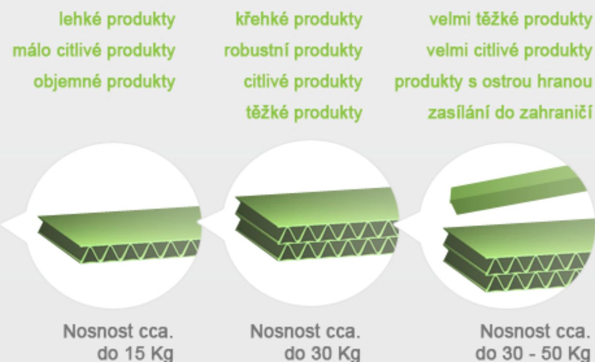
Druhy vlnitých lepenek 3-vrstvá, 5-vrstvá nebo 5-vrstvá s výztužemi.
